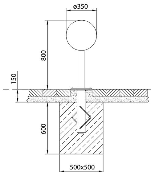
B.) Einbau mit 400 mm Fundamentüberdeckung
