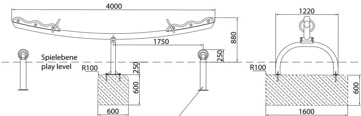
Bei lockerem Boden einbetonieren
